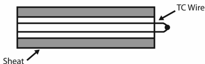
รูปที่ 20 โครงสร้างเทอร์โมคัปเปิ้ลแบบ Exposed หรือ Bare Wire Junction
